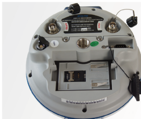
Geräteunterseite mit SIM-Karten-Slot, Antennen- und NMEA-Anschlüssen
