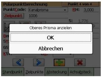
–Zielen Sie das obere Prisma an und bestätigen das Auslösen der Messung mit <OK>
