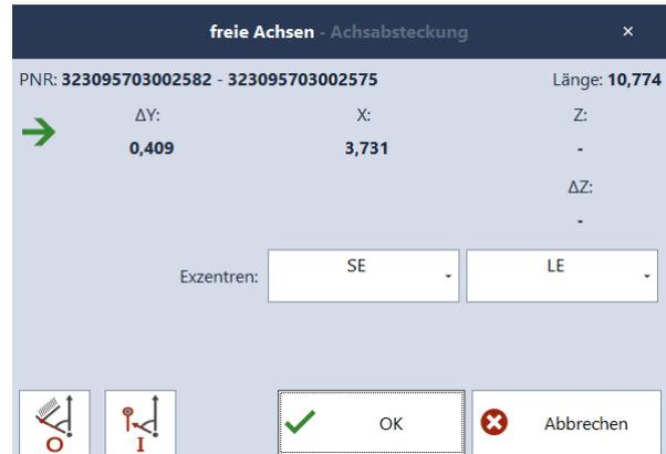
Verschieben Sie das Prisma auf der Y-Achse in Richtung des grünen Pfeil.
