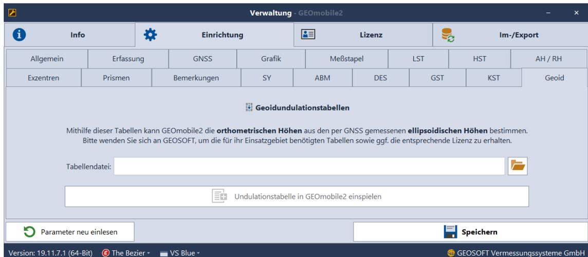
**GEOMobile2** übernimmt von GNSS Antennen grundsätzlich eine ellipsoidische Höhe.
